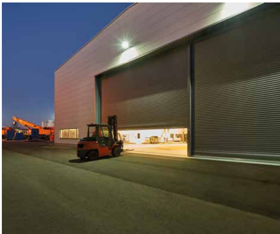
Door de combinatie van meerdere roldeuren / rolhekken DD met de verschuifbare middenstijl SSG DD kunnen openingen tot 36 m breed en 9 m hoog worden gesloten.
